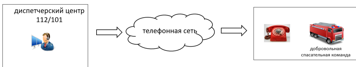
Рис. 4. Упрощенная схема передачи информации по стационарному телефону
